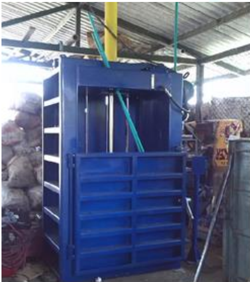
Foto Vallecaucana de Aguas S.A.-E.S.P/ Compactadora Hidráulica Alcalá
